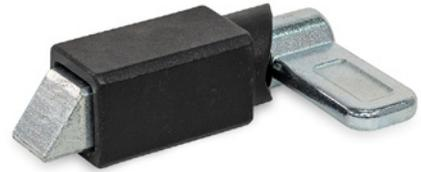
Die Maßtoleranzen zwischen Bolzen und Führung sind so gewählt, dass die Funktionssicherheit auch nach dem Schweißen, dem Aufbringen einer Korrosionsschutzschicht oder bei Verschmutzung gewährleistet ist. Bei der Form AU muss die Rastmechanik bei der Montage geschmiert werden, bei den Formen A1, A2, A3 und A4 ist sie im Lieferzustand geschmiert. Die Rastmechanik kann bei Bedarf nachgeschmiert werden.
